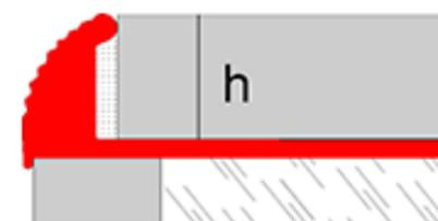
Perfil redondeado de PVC que se emplea como cantonera para proteger y decorar esquinas de paredes revestidas con baldosas cerámicas. Se coloca fácilmente en el ángulo formado por el revestimiento.
